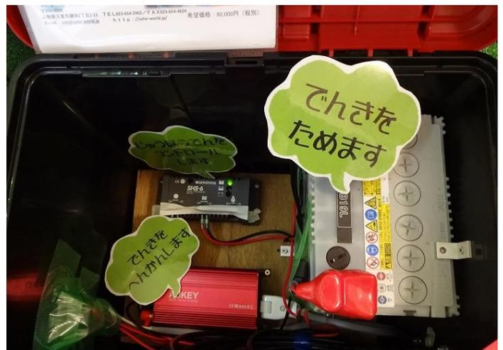
図書館の中にソーラーパネルが！しかも、発電しているんです。ソーラーパネルの横には、電気を貯める装置が置いてあり、どんな仕組みになっているのを見ることができます。
